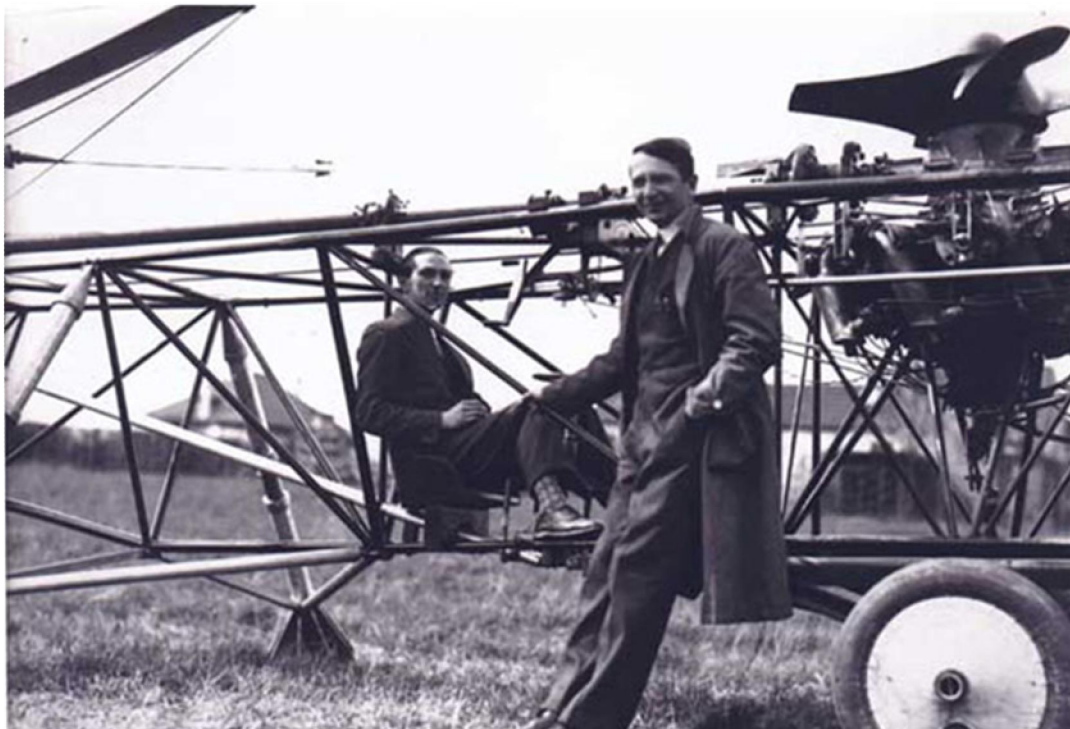
Gemonteerd in het midden van het draagframe bevindt zich een ventilator met 4 houten bladen gemonteerd boven op de stervormige motor met 9 cilinders Renard 200. Nicolas Florine, de uitvinder, bevindt zich rechtstaand aan de zijde van de ingenieurpiloot Robert Collin, gezeten op de pilotenpost. Voor grondverplaatsingen wordt de helikopter steeds op een wagen geplaatst.
