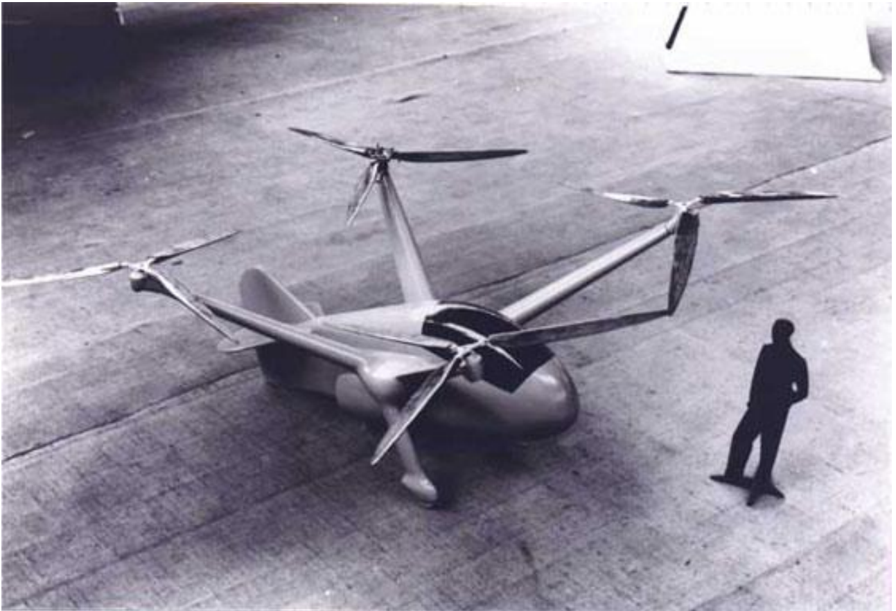
Zicht in de windtunnel op de proefmaquette (schaal 1/5) van het project Florine IV. De realisatie hiervan werd gelanceerd na de 2 de Wereldoorlog. Deze maquette werd gerestaureerd door het Instituut voor dynamische Vloeistofmechanica van Karman en wordt getoond in de Sectie Lucht en Ruimtevaart van het Koninklijk Museum van het Leger en de Krijgsgeschiedenis te Brussel.
