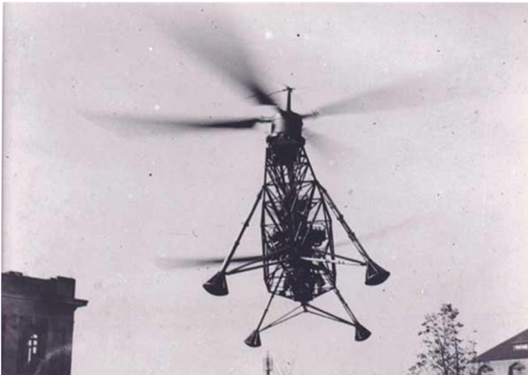
Vooraanzicht van de Florine II, in stationaire vlucht. Hier ziet men duidelijk de helling van de rotorassen waarvan de hellingshoek zodanig werd berekend dat de reactiekoppels van de rotors zichzelf ophieven.
