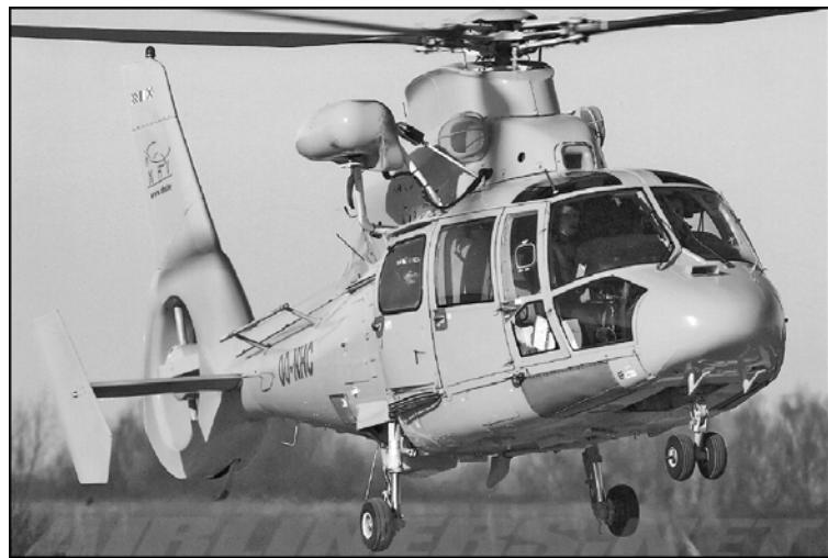
En vol stationnaire, un hélicoptère bimoteur Aérospatiale AS 365N3 de la société NHV. C'est une version « navalisée » du Dauphin. On remarque le puissant treuil utilisé pour la mise à bord de pilotes sur les navires avant leur entrée dans les ports.
