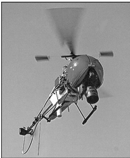
Le berceau orientable et stabilisé de la caméra permet le choix de l'angle de vue le mieux adapté, notamment comme ici pour les prises verticales.
