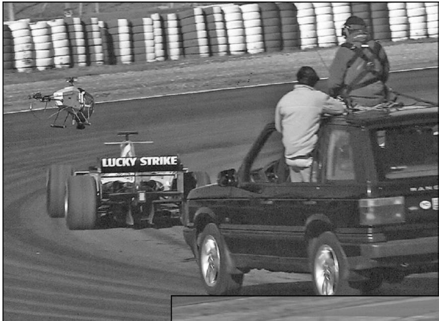
Un Flying Cam II filme en continu et en vues rapprochées le comportement en piste d'une BAR-Honda de Formule 1 à l'entraînement. Installés sur une voiture rapide, le pilote dirige l'hélicoptère selon la trajectoire de la monoplace tandis que l'opérateur caméra braque par radiocommande l'appareil de prise de vues sur la voiture et règle le zoom de l'objectif.
