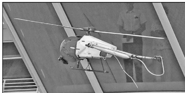
Son faible encombrement et sa parfaite maniabilité permettent au Flying Cam II de faire évoluer en sécurité cette caméra héliportée à proximité immédiate de la scène à photographier ou à filmer.
