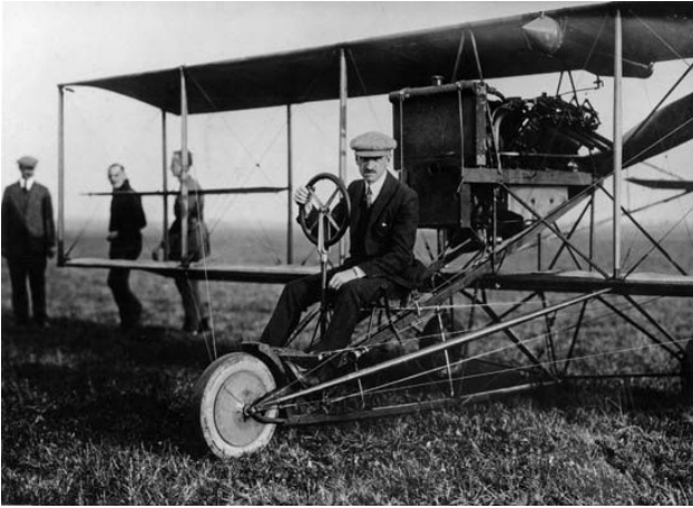
Let op de rolroeren achteraan de vleugels On remarque les ailerons au milieu des ailes
