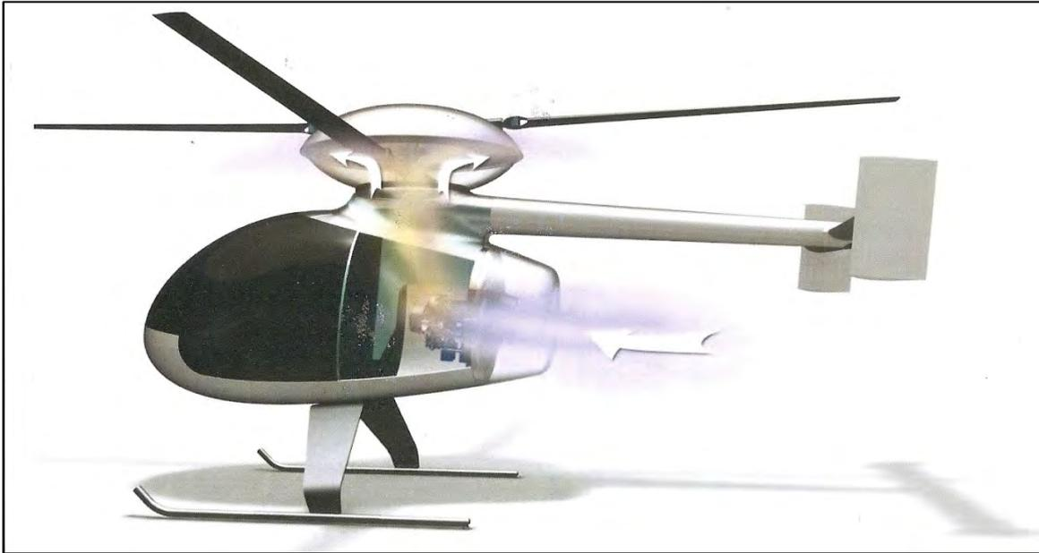
*Le concept REDT – L'air aspiré à l'arrière du fuselage est comprimé par le fan. Une partie du flux alimente le moteur ; le reste est réchauffé puis dirigé vers la grande coupole lenticulaire pour transmettre sa puissance aux aubages des turbines qui entraînent les deux demi-coupoles et les rotors contrarotatifs. L'air s'échappe alors vers l'extérieur par la fente entre les demi-coupoles.*
