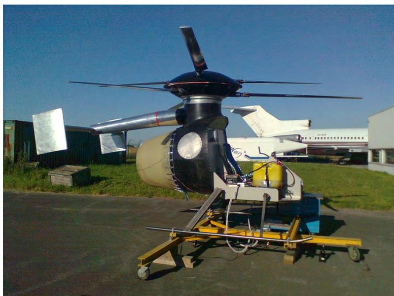
*Le démonstrateur statique (Iron Bird) dans les installations de WAN à Gosselies. Il permet de tester en fonctionnement le moteur à combustion, la soufflante et l'efficacité de la veine d'air sur les turbines entraînant les demi-coupoles et les rotors contrarotatifs qui, sur cet appareil d'essai, sont tripales.*
