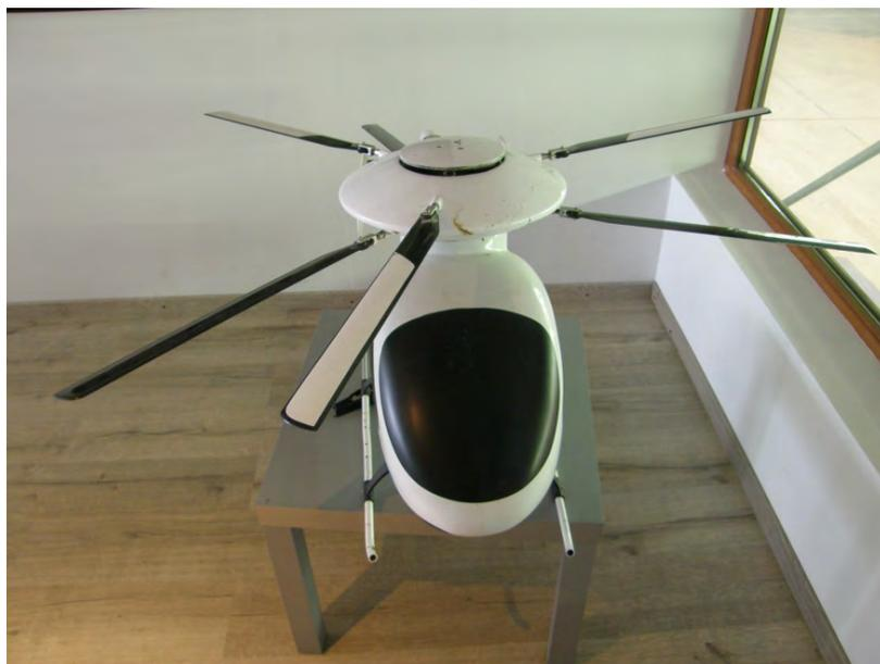
*La maquette télécommandée (échelle 1/5) dont les vols ont démontré la faisabilité du concept REDT. Différences avec le prototype du Sherpa aujourd'hui en développement : a) les rotors sont ici tripales ; b) le train d'atterrissage n'est pas mono lame ; c) la propulsion est électrique. Les vidéos de deux vols peuvent être vues sur [www.sagita.be](http://www.sagita.be) .*
