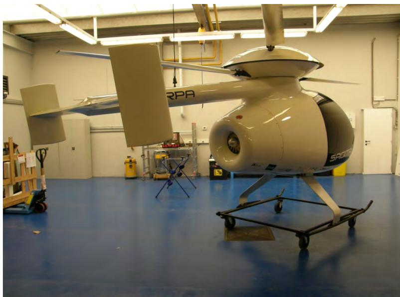
Pour augmenter l'efficacité du contrôle en lacet de l'hélicoptère en vol stationnaire, le concepteur a choisi d'utiliser l'effet Coanda engendré par le souffle vertical des rotors sur la poutre de queue. À cet effet, dans les flancs latéraux de celle-ci sont aménagées de fines fentes longitudinales qui peuvent être ouvertes ou fermées sous l'action des commandes de vol.
