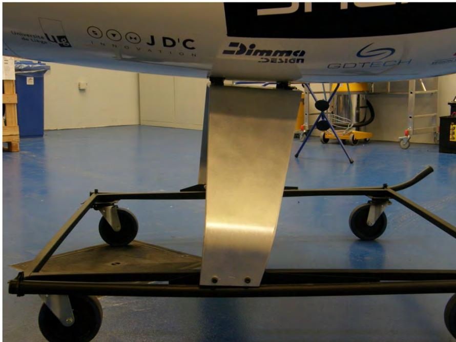
*Gros plan sur l'atterrisseur mono lame boulonné au châssis.*
