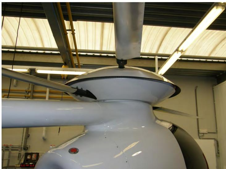
*Gros plan sur les demi-coupoles contrarotatives dans lesquelles sont intégrés les rotors bipales ; on voit la fente d'échappement de l'air.*
