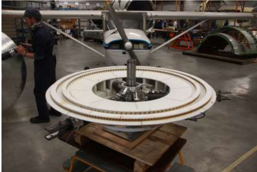
In de werkplaats, een turbine met de twee rijen concentrische schoepen
