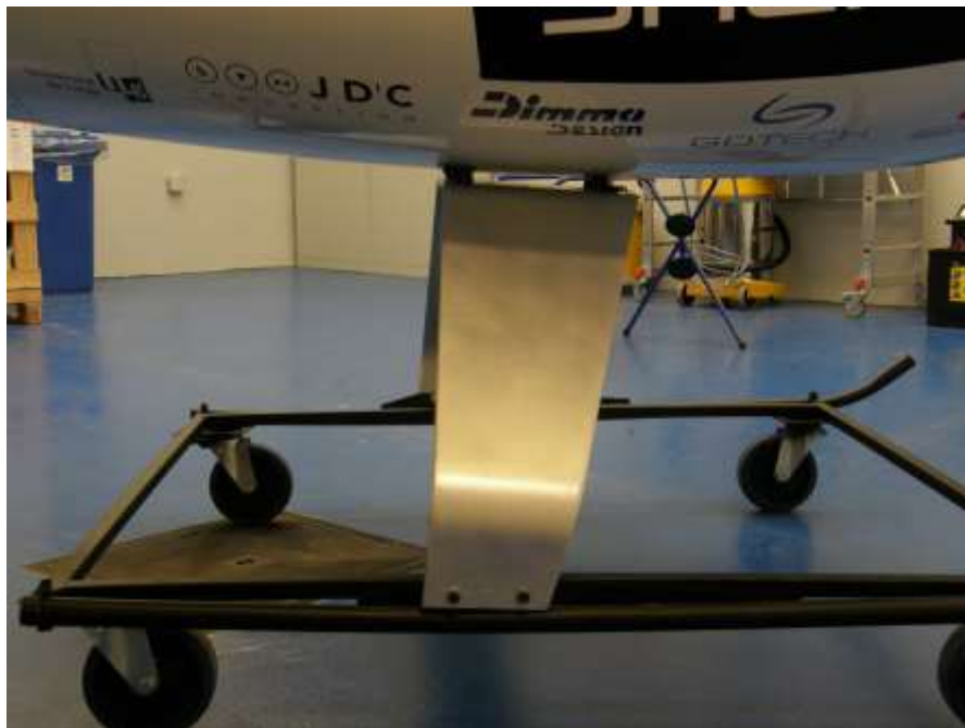
Zicht op het enkel bladig landingsgestel met bouten aan het frame bevestigd
