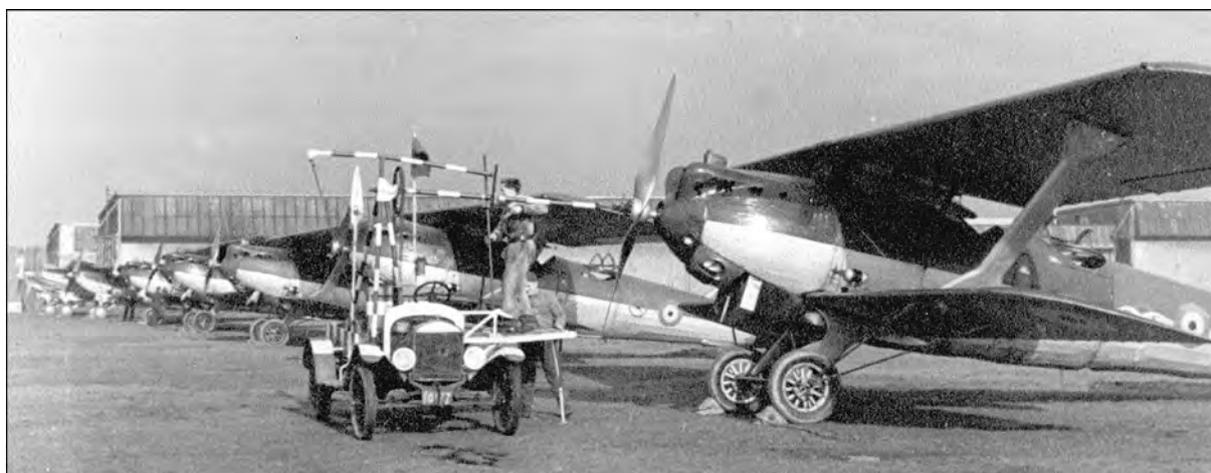
*Les mécaniciens préparent les Bréguet XIX affectés à l'école d'aéronautique début 1939; à l'avant-plan, le « Hucks starter » permettant de démarrer les moteurs sans avoir à lancer l'hélice à la main.*
