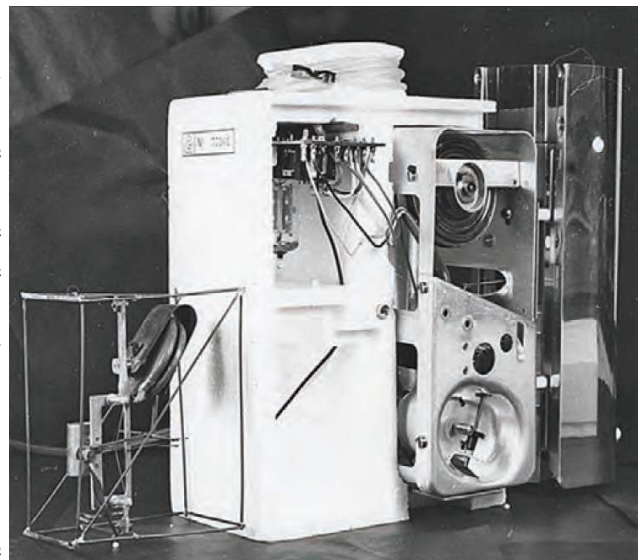
Algemeen zicht op de meteorograaf van Jaumotte voor peilingen met een vliegtuig (rechts) en links hiervan de lichte meteorograaf voor metingen met een peilballon. (Archief KMI)
