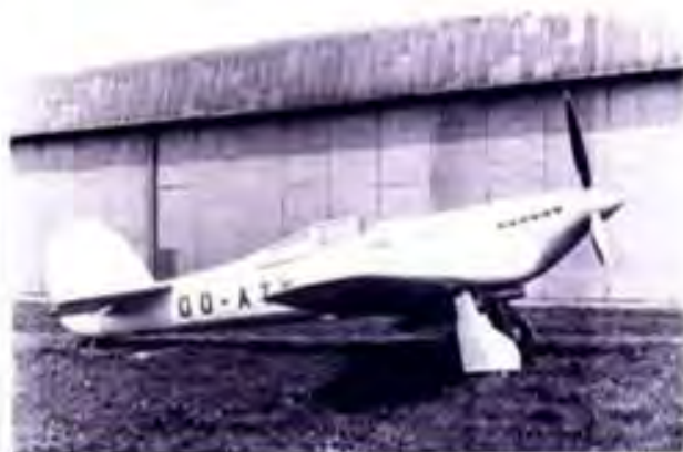
Prototype van een ééndekker jachtvliegtuig met lage vleugelinplanting, ontworpen in 1936/1937. De R-38 versie op de foto is uitgerust met een Rolls-Royce motor Merlin II.
