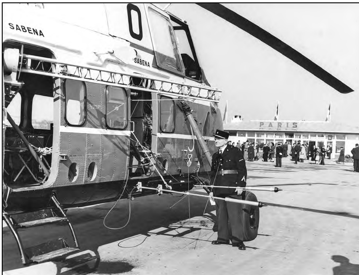
Le vol en groupe des S-58C vers Paris du 3 mars 1957 fit l'objet, depuis le départ de Bruxelles, d'une retransmission télévisée franco-belge en direct de l'événement, d'où le flanc droit de la cabine de l'hélicoptère TV hérissé d'antennes qui intriguent fort un policier français. On était encore loin du multimédia !
