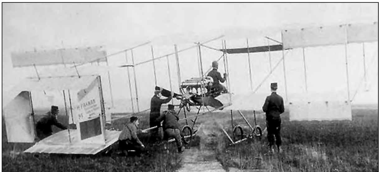
Le premier avion militaire de l'armée belge (numéro de constructeur 93), le Farman HF III/type militaire 1910, avec le Lieutenant Georges Nélis au poste de pilotage en mai 1911, peu avant le démarrage du moteur avec l'escouade de mécaniciens prêts à retenir l'avion lorsque l'hélice se mettra à tourner. (AELR/MRA-KLM)
