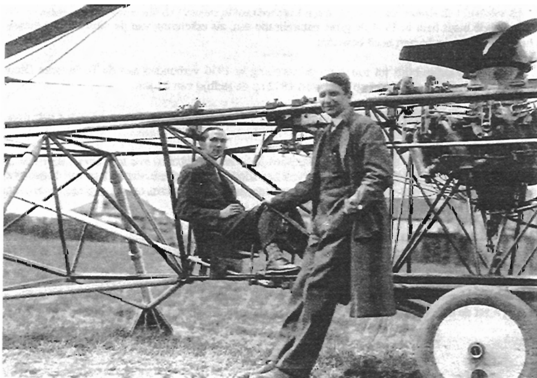
De 9-cilinder stermotor Renard 200 is midden de romp gemonteerd met daarboven een vierbladige houten ventilator. Uitvinder Nicolas Florine staat naast de ingenieur-vlieger Robert Collin die in de stuurhut zit. De helikopter rust nog op de transporttrolley.
