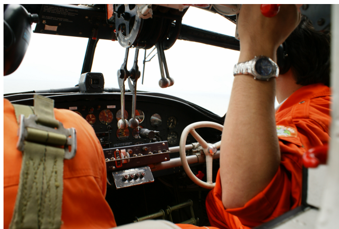
Un poste de pilotage étroit, un tableau de bord à l'ancienne, les manettes de commande de pas d'hélice et de gaz suspendues, nostalgie du Catalina... (JP Decock)
