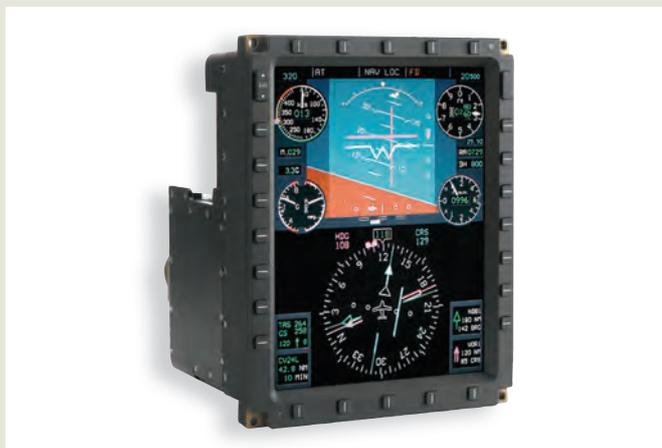
*Instrumentation LCD Barco sur Iliushin-114 et Tupolev-204
