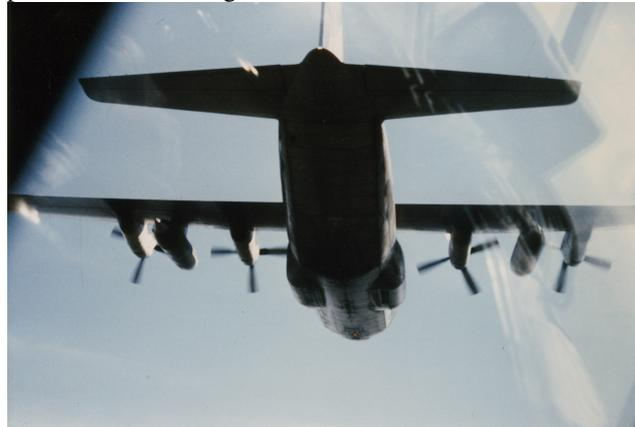
We hebben ook enkele C-130's gebruikt als brandstoftankers, door ze van soepele tanks te voorzien. In Kinshasa laadden we 22 of 23 ton brandstof, we vulden ook volledig de vliegtuigtanks en stegen op in overgewicht. De startbaan van Kinshasa heeft een lengte van 15000 voet en we gebruikten er 14000 van. Bij aankomst, twee uur later te Kamina, hadden we 8000 pond brandstof verbruikt en moesten we zo zacht mogelijk landen om breuk van het onderstel te vermijden.
