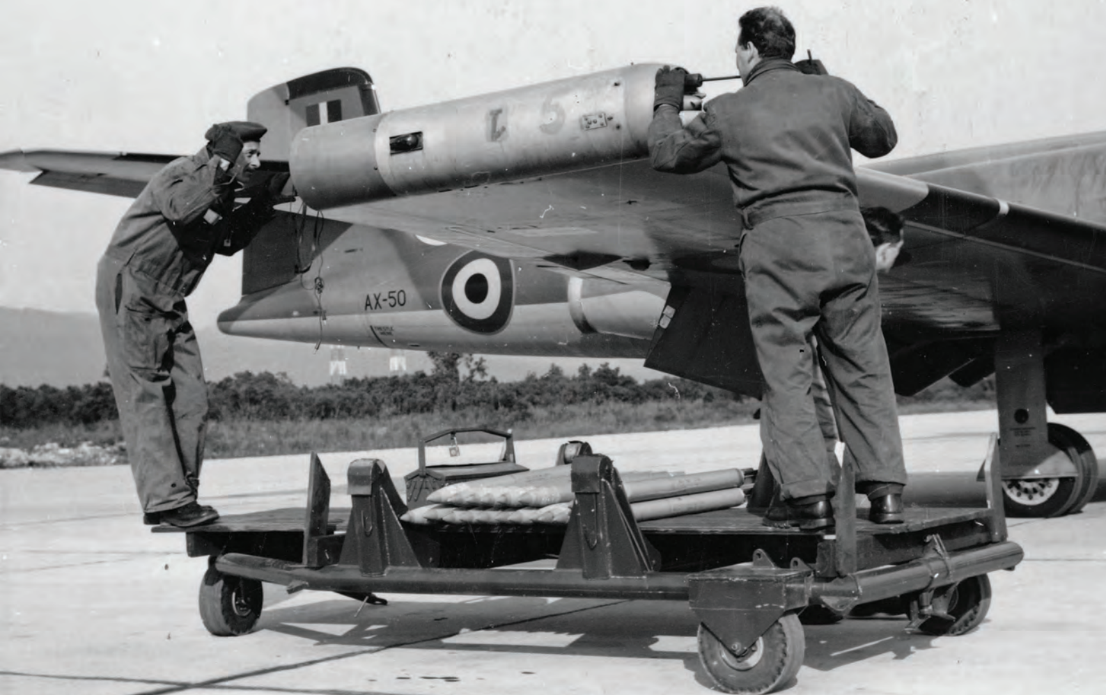
Les roquettes pods. Les mécaniciens chargent des roquettes utilisées pour les exercices de tir.
